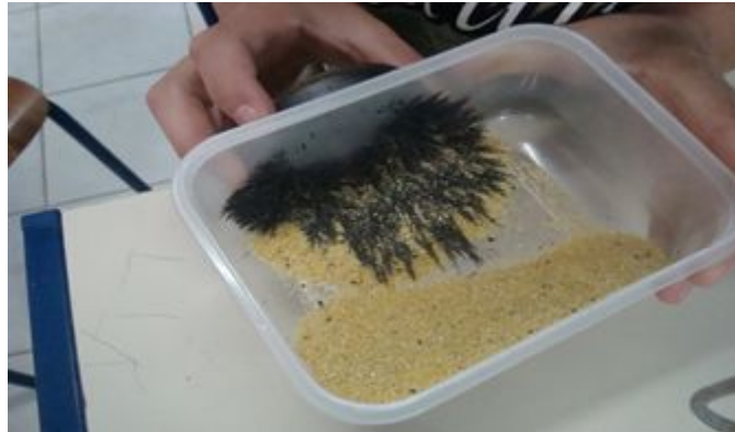
Separação de limalha e areia – uso de um ímã onde a limalha é atraída pelo ímã.
