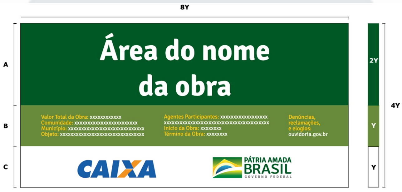
Figura 01 – Detalhe placa da obra
