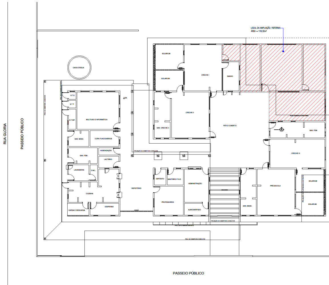
IMPLANTAÇÃO - PLANTA DE LOCAÇÃO DA AMPLIAÇÃO Escala: 1/100
